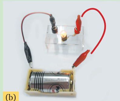
Gambar 5.1 Rangkaian Menyalakan Lampu dengan Baterai, (a) Rangkaian Terbuka, (b) Rangkaian Tertutup
